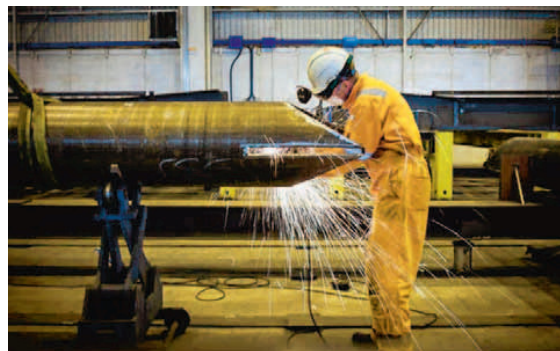
PÅ DYPT VANN. Majcher Krzysztof kutter og sliper stålrør som skal sveises sammen til undervannsrammer ved Aker Solutions' fabrikk i Sandnessjøen.
